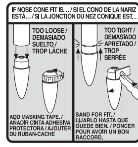
IF NOSE CONE FIT IS... / SI EL CONO DE LA NARIZ ESTÁ... / SI LA JONCTION DU NEZ CONIQUE EST... TOO LOOSE / DEMASIADO SUELTO / TROP LÂCHE TOO TIGHT / DEMASIADO APRETADO / TROP SERRÉE ADD MASKING TAPE / AÑADIR CINTA ADHESIVA PROTECTORA / AJOUTER DU RUBAN-CACHE SAND FOR FIT / LIJARLO HASTA QUE QUEDE BIEN / PONCER POUR AVOIR UN BON RACCORD.
