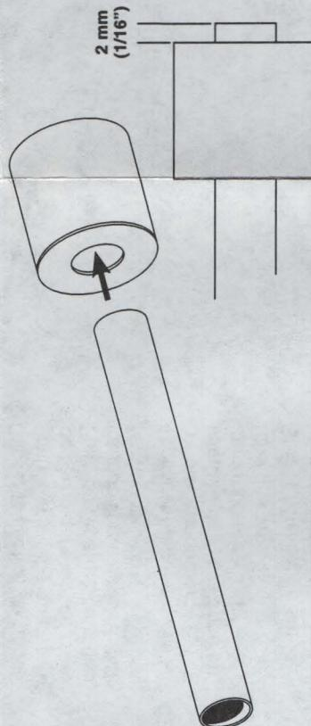
2. Das Rohr mit dem kleineren Durchmesser so weit durch den Ring schieben, bis es 2 mm herausragt.
