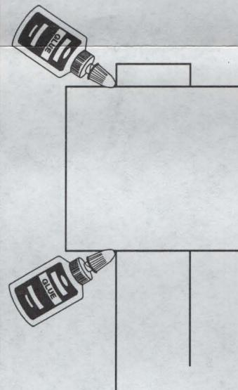
3. Klebstoff um das Rohr und die Ringverbindung auftragen.
